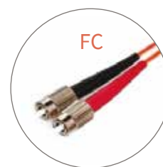
Connecteur FC (Ferrule Connector) Connecteur rond avec système à vis, très utilisé sur les réseaux longues distances en fibre monomode et environnement à vibrations importantes. Conforme à la norme CEI 61754-13
